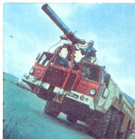
Автомобиль для тушения пожаров на аэродромах АА—60 (7310). Шасси — МАЗ—7310; мощность двигателя — 525 л. с./386 кВт; число мест для боевого расчета — 4; вместимость цистерны для воды — 12 000 л; подача насоса — 60 л/с; пропускная способность лафетного ствола: воды — 60—70 л/с, пены — 36 м 3 /мин; полная масса — 42,4 т.
