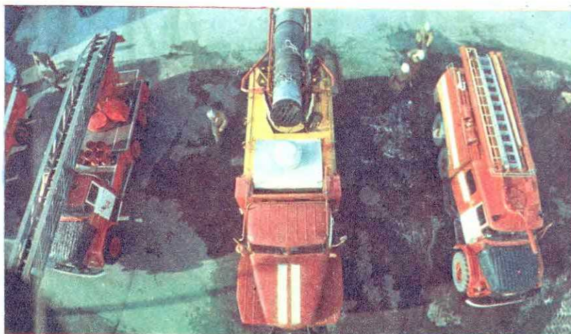
Автомобиль для тушения пожаров на аэродромах АА—60 (7310). Шасси — МАЗ—7310; мощность двигателя — 525 л. с./386 кВт; число мест для боевого расчета — 4; вместимость цистерны для воды — 12 000 л; подача насоса — 60 л/с; пропускная способность лафетного ствола: воды — 60—70 л/с, пены — 36 м 3 /мин; полная масса — 42,4 т.
