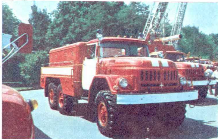
Серийные машины, состоящие на вооружении пожарных частей (слева направо): лестница АЛ—30 (131), автомобиль газодымового тушения АГВТ—150 (375), автоцистерна АЦ—40 (131).
