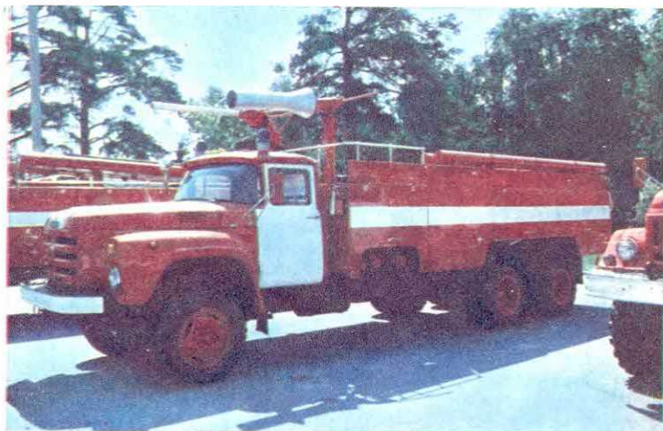
Автомобиль АКТ—2/2,5 (133) комбинированного тушения легковоспламеняющихся материалов. Шасси — ЗИЛ—133ГЯ; мощность двигателя — 210 л. с./154 кВт; число мест для боевого расчета — 3; вместимость цистерны для воды — 2500 л; запас порошка — 3000 кг; подача насоса — 40 л/с; дальность водяной струи — 70 м; полная масса — 16,8 т.
