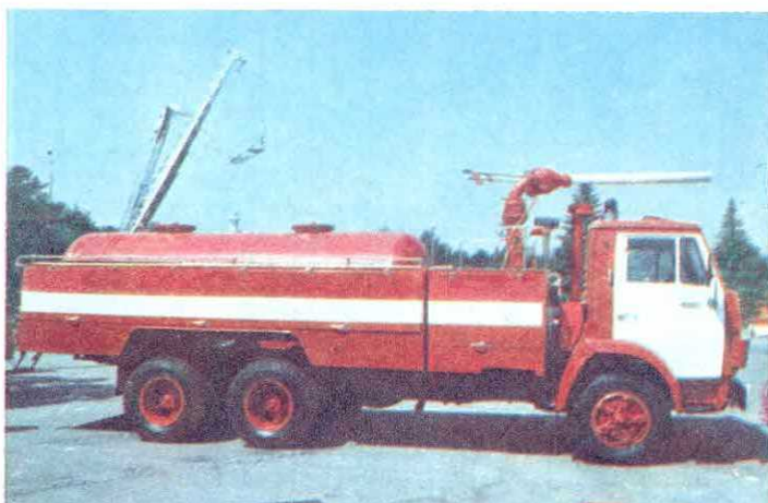
Автомобиль для тушения пожаров на аэродромах АА—60 (7310). Шасси — МАЗ—7310; мощность двигателя — 525 л. с./386 кВт; число мест для боевого расчета — 4; вместимость цистерны для воды — 12 000 л; подача насоса — 60 л/с; пропускная способность лафетного ствола: воды — 60—70 л/с, пены — 36 м 3 /мин; полная масса — 42,4 т.
